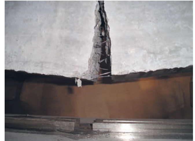
Bild 8: Vier-Punkt-Biegezugversuch an Betonbalken mit Stahlfasern [88]. Foto: Monika Helm
