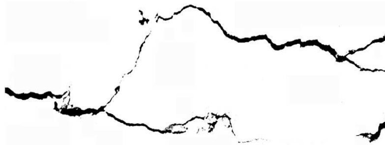
Bild 1 Realer Riss mit veränderlicher Rissbreite und Rissverzweigungen
